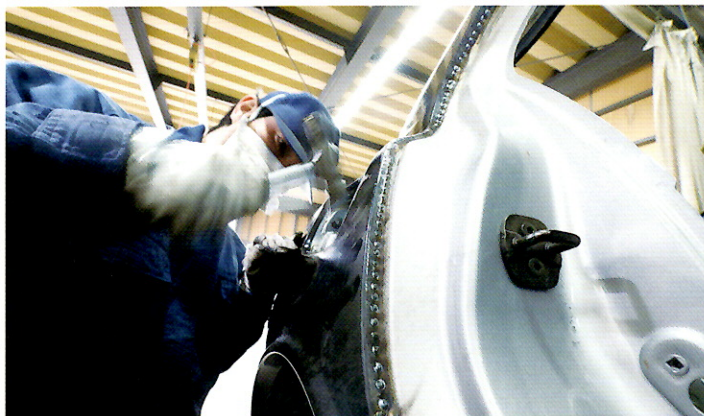
当金（あてがね）という鉄塊を叩きながらハンマーでたたき、ひとつひとつひずみを除去。これは根気がいりそう。
