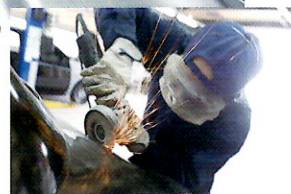
火花を飛ばしボディを平滑に削る作業。瞬きを忘れ見入ってしまいました。
